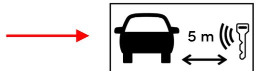
**1b. Desactivación del sistema de alto voltaje, como alternativa de 1a**
