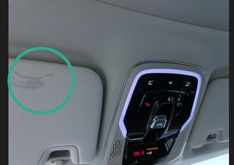
Risse und Schäden im Material.
