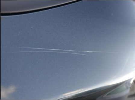
Kratzer und Lacksplitter, die den Lack nicht beschädigen.
