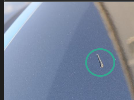
Schäden an der Karosserie, z. B. Beulen oder Kratzer, bei denen die Lackschicht bis auf die Grundierung beschädigt ist.
