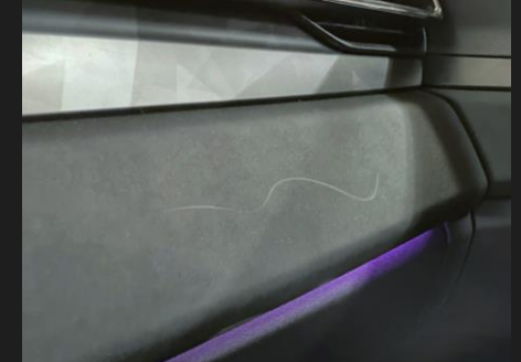
Schäden durch den Transport verschiedener Gegenstände im Auto
