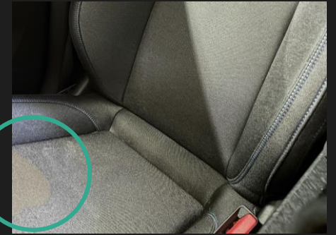
Verfärbungen oder Schimmel am Innenmaterial.
